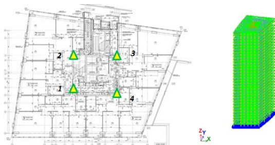
Рис. 1. План расположения инклинометров и расчетная модель корпуса №1
