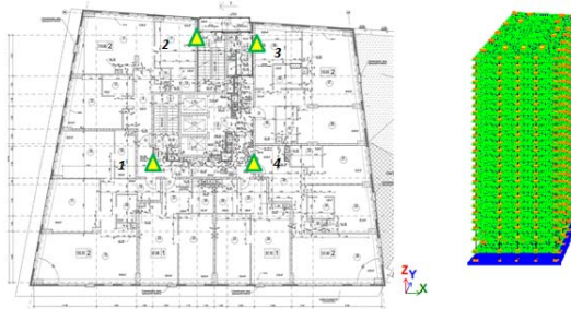
Рис. 4. План расположения инклинометров и расчетная модель корпуса №4
