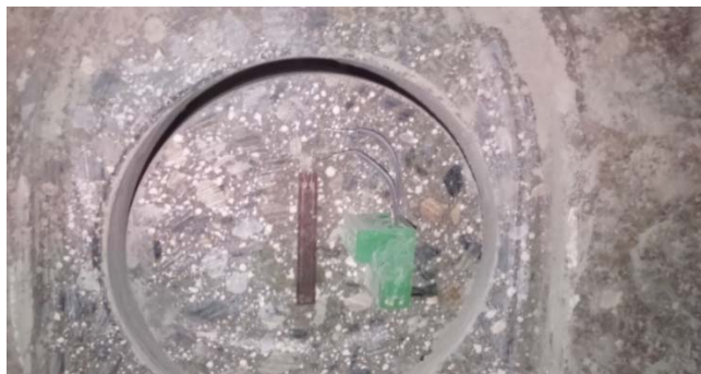
Рис. 7. Расположение тензорезистора на участке разгрузки
