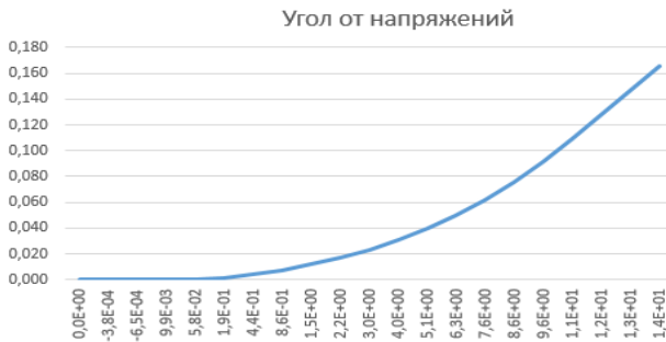
Рис. 9. График угла поворота от напряжений балки d22
