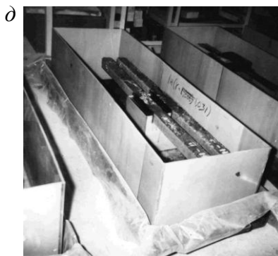
Рис. 2. Этапы изготовления и подготовки опытных элементов к испытаниям а – формование элементов без предварительного напряжения; б - то же, предварительно напряженных; в - обработка элементов сухим прогревом; г - передача предварительного напряжения на бетон; д - выдержка предварительно напряженных образцов в воде и растворе серной кислоты
