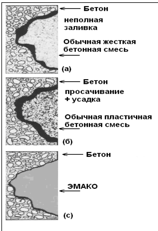
Рис.2. Ремонт выполненный: жесткой бетонной смесью – в результате не обеспечен полный контакт между старым и новым бетоном (а), пластичной бетонной смесью – произошел отрыв по контакту из-за усадки в процессе твердения (б), материалом ЭМАКО (с)
