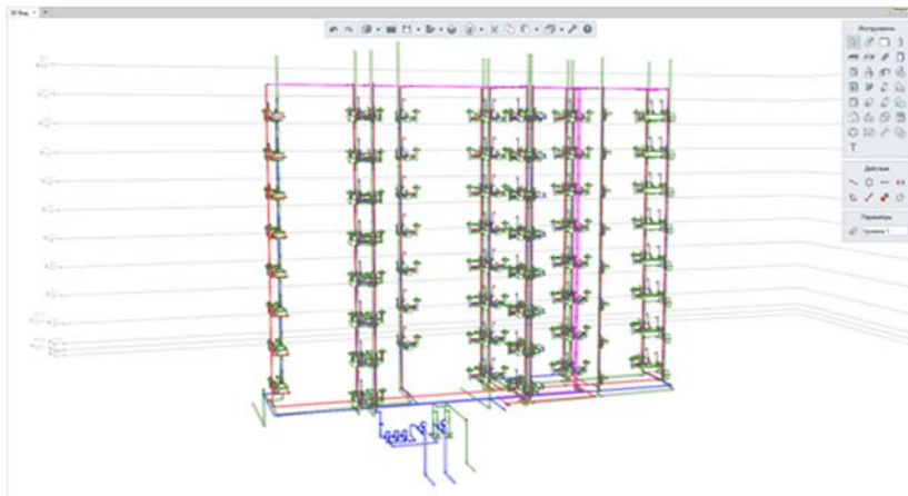
Рисунок 4 – Интерфейс Renga. Аксонометрия сетей водоснабжения и водоотведения
