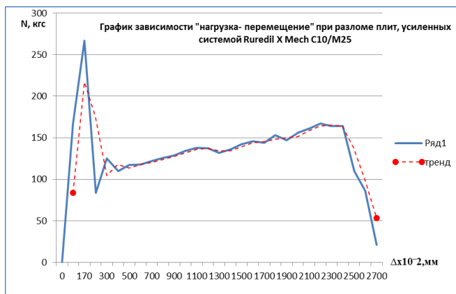
Рис.13. Кривая, характеризующая поведение системы «Камень - усиление - крепление» по параметрам "нагрузка- перемещение" при наложении всех этапов нагружения по схемам 1 и 2 и длительном нагружении до обрушения мест крепления резьбовых консолей со штифтом марки HALFEN HS- 1,6-2-A4. Момент разлома плиты выявляется на левом пике. Момент обрыва камня в местах крепления штифтами – на правом пике, после достижения смещения плиты вниз от места закрепления более 25мм.
