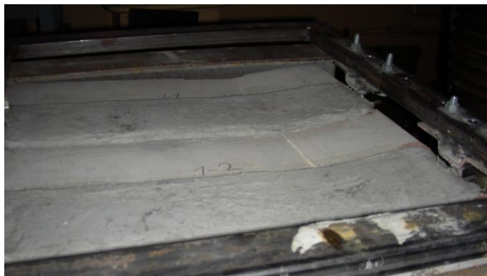
Рис. 9. Вид усиленной по схеме 1 плиты после разрушения по схеме нагружения 1. Общий прогиб плиты составляет 20мм. Наблюдается начало отрыва одной полосы усиления в зоне разлома плиты (трещина длиной 19мм, наибольшее раскрытие 2мм).
