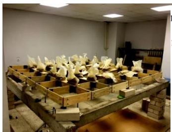
Рис. 5- Загружение СПБ сосредоточенной нагрузкой в центральных узлах
