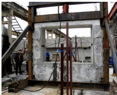
Рисунок 2. Испытания перемычной и простеночной частей
