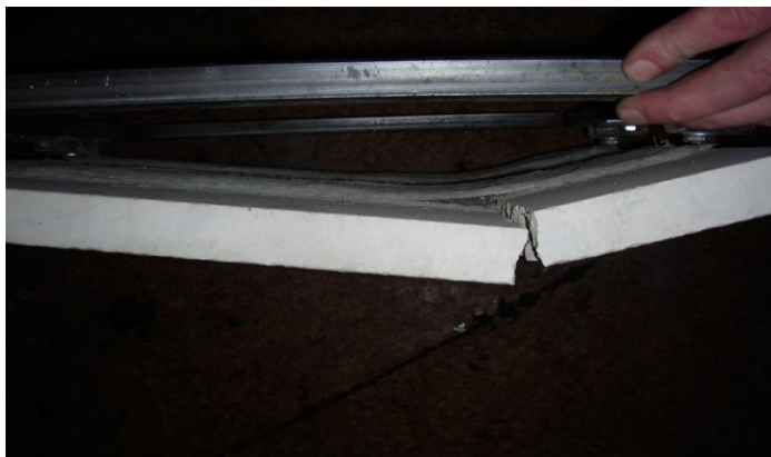
Рис.11. После снятия нагружения по схеме 1 плиты способны нести свой вес, при движениях устойчиво сохраняют свое положение. Наблюдается упругость системы усиления Ruredil X Mech C10/M25.
