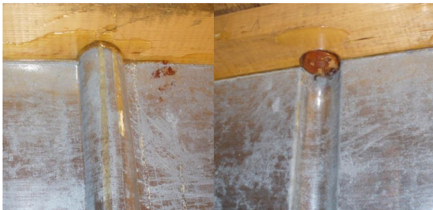
Рис. 5. Состояние клеевого соединения после испытания балки на изгиб
