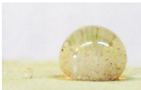
Рис. 2. Капля воды на поверхности таблетки, отпрессованной из порошка.
