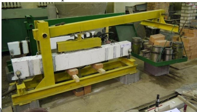
б) Рис. 2. Схема опирания и нагружения исследуемых балок (а), рычажная установка для испытания опытных балок (б)
