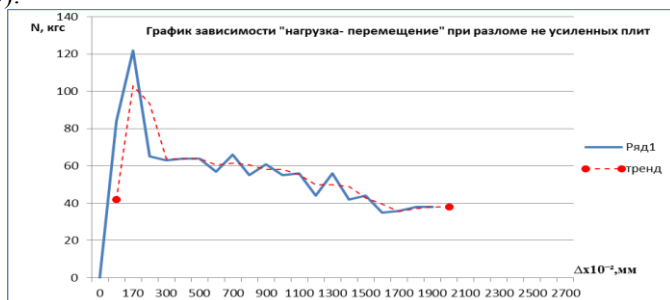
Рис. 5. График зависимости «нагрузка – перемещение» при разрушении не усиленной плиты при схеме нагружения 1
