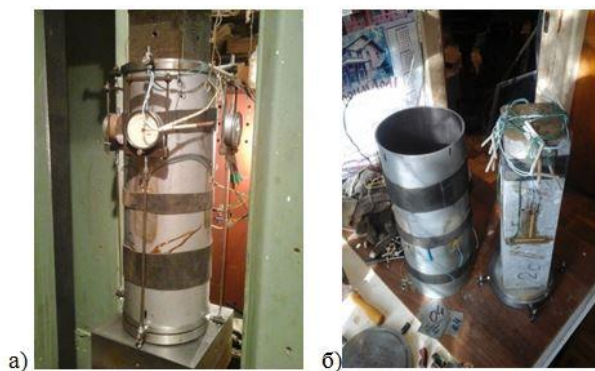
Рисунок 5 – Испытания опытных образцов получения полные диаграмма деформирования а)- перед испытанием б)- после разрушения
