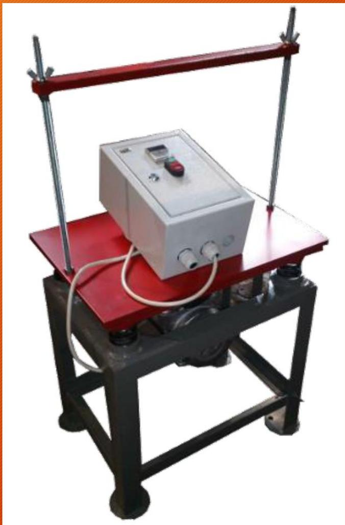
Виброплощадка лабораторная типа СМЖ-539 предназначена для уплотнения бетонных и растворных смесей при:
