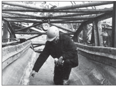
Рис. 2. Фрагмент продольного полосового износа верхней рабочей обкладки резиноканвеевой ленты конвейера
