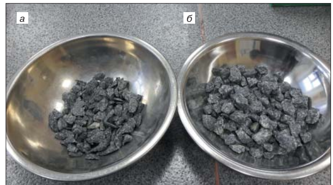
Рис. 4. Внешний вид щебня фракции 10–20 мм из габбро-диабазы, полученного с использованием дробилок ДЩ 100×200 (а) и 2ЩДС 100×200 (б)
