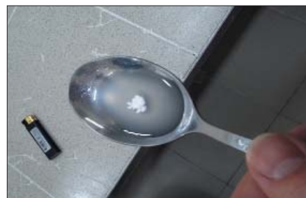
Рис. 3. Конкурентный поликарбоксилатный пластификатор через 30 с нагрева
