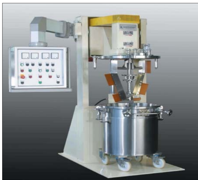
Рис. 2. Экспериментальный смеситель объемом 100 л
