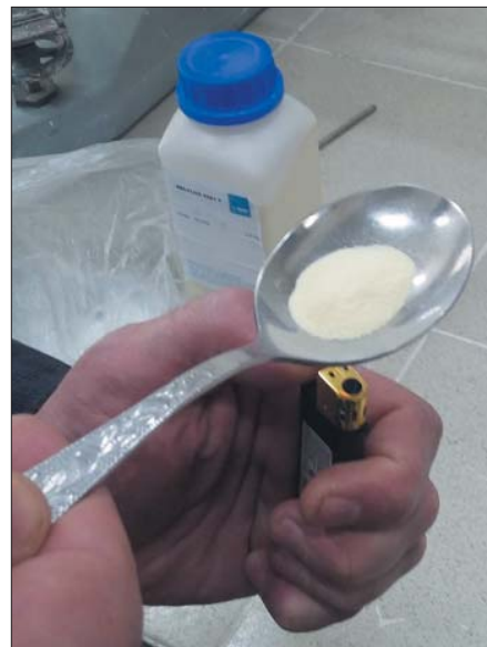
Рис. 4. Melflux 5581F после нагрева в течение 30 с
