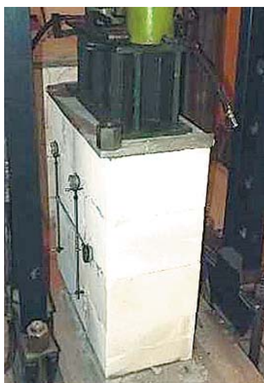
Рис. 2. Опытный образец в нагружающем устройстве
