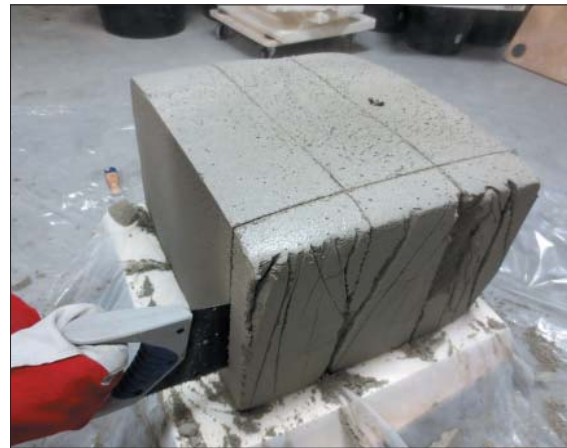
Рис. 5. Первое изделие с пониженным содержанием цемента
