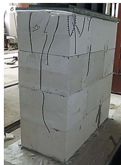
Рис. 3. Характер разрушения образцов кладки: а – на полиуретановых швах; б – на полимерцементных клеевых швах
