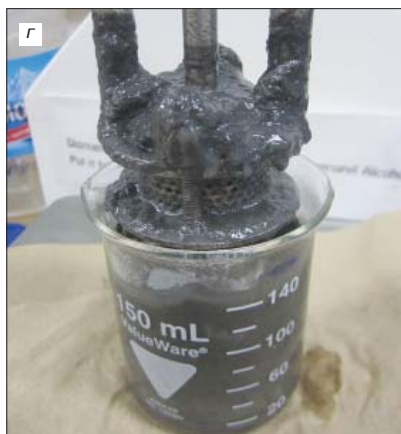
Рис. 5. Эмульсии, приготовленные с содержанием микрокремнезема в количестве: а – 1%; б – 5%; в – 7%; г – 10%
